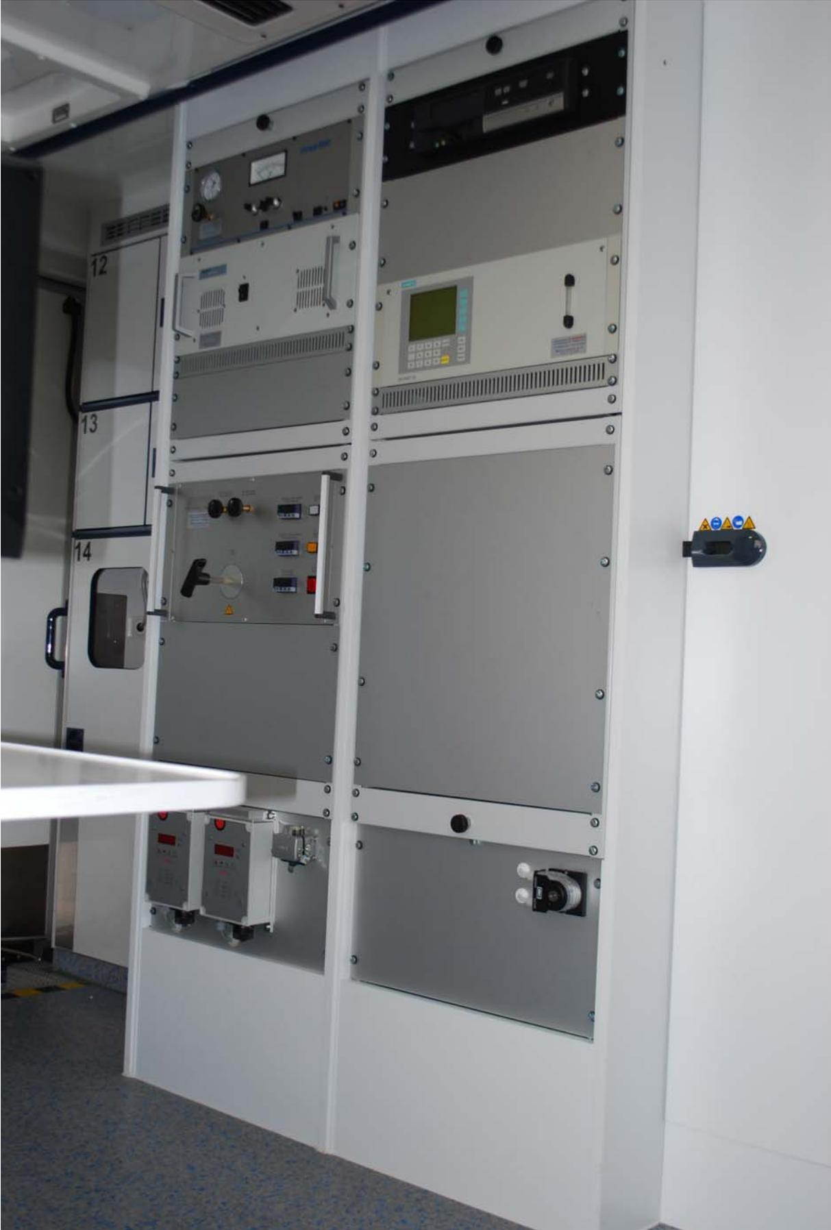
Im Schrank rechts neben den Analysegeräten haben die Tanks für Frischwasser und Kondensat Platz gefunden. Darüber sind die Module für Datenübertragung und Netzwerkanbindung montiert. Ferner kann hier der optionale Drucker platziert werden.
