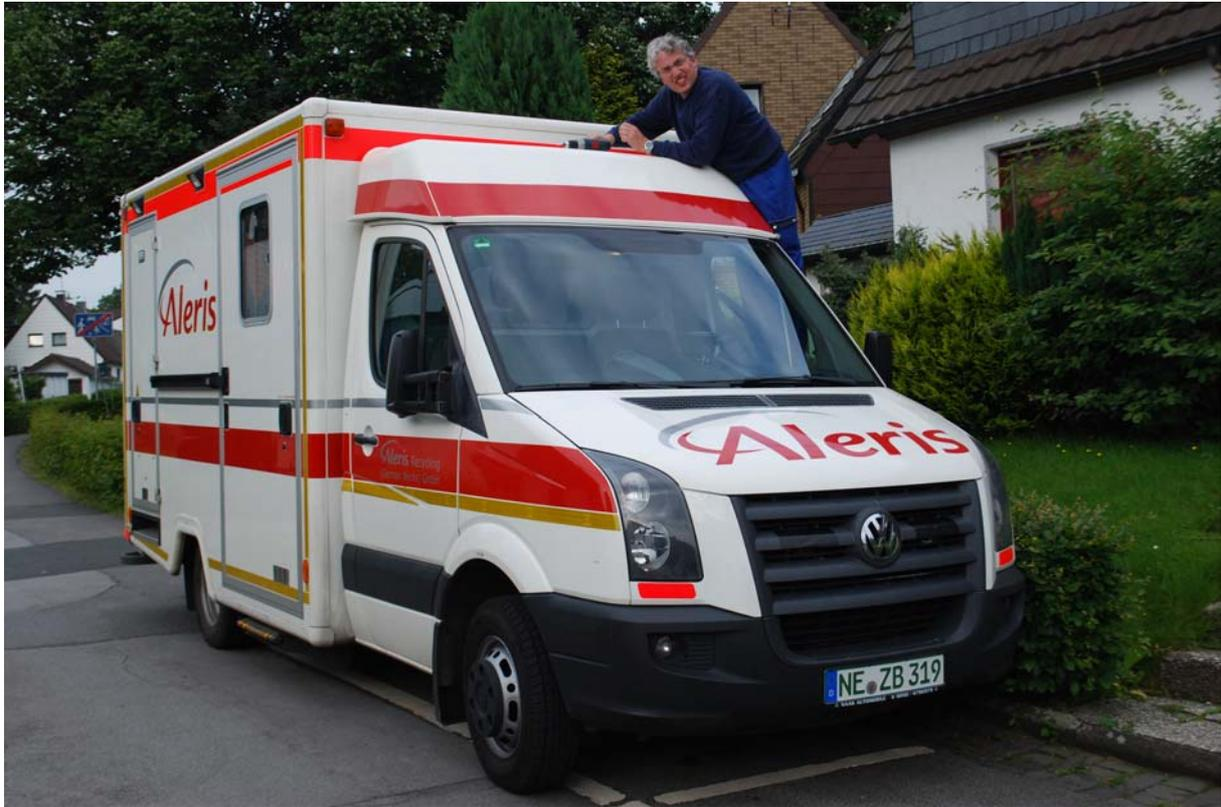
Viele Schritte vom Rettungswagen zum Messmobil – Hier die Beseitigung von letzten Spuren der Signaleinrichtungen auf dem Dach. Auch ohne Blaulichter ein auffälliges und markantes Fahrzeug, das weder beim Einsatz auf dem Werksgelände, noch auf der Straße übersehen wird. Ein 24-Stunden-Einsatz der Außenbeleuchtung/ Blinkanlage ist bei Netzbetrieb möglich!
