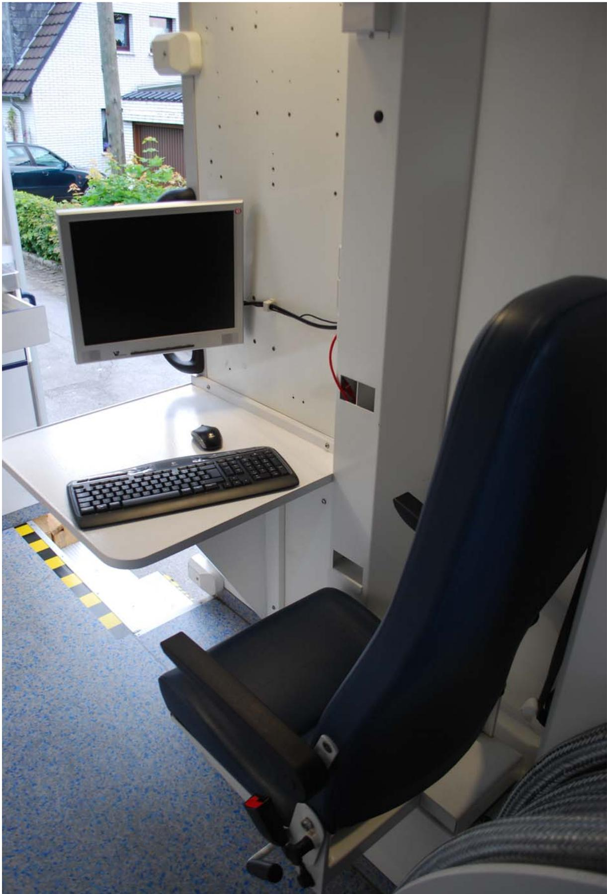
Hinter dem Stuhl des PC-Arbeitsplatzes befindet sich die Haspel für die Messgasschläuche. Intelligente Raumnutzung: Unter den Schläuchen versteckt sich – für den Notfall – das Ersatzrad.
